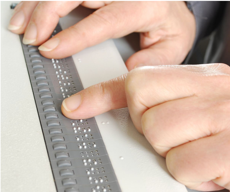
Abb. 10.1 Ein Screenreader erfasst Text auf dem Bildschirm und gibt ihn auf ein Braille-Gerät aus
